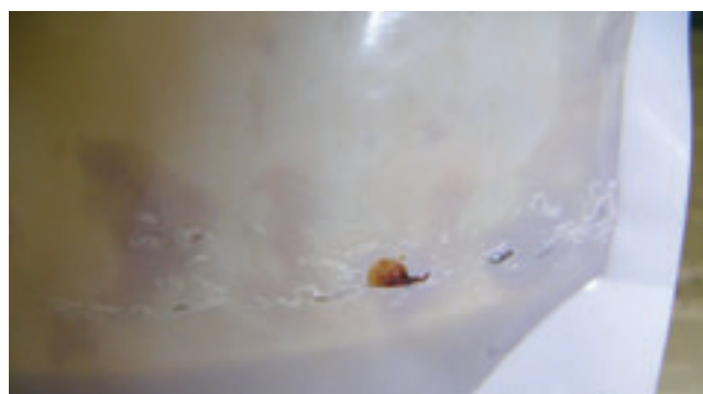
図1 穴あき例(ビーフシチュー) パウチ: バリアPET/ナイロン/PP 加熱: 500 W・3分間
