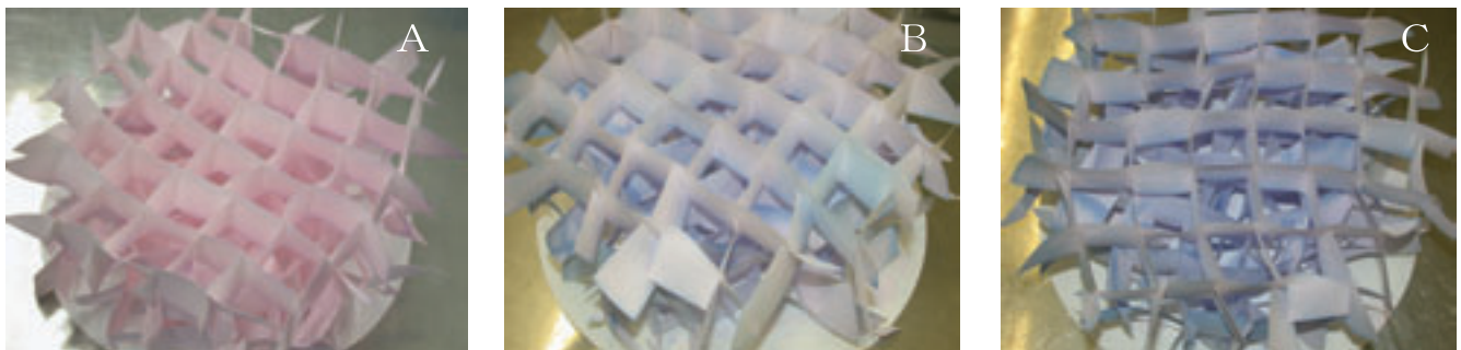
図2 加熱むらの確認(立体) 単機能電子レンジ・750 W A: 0秒 B: 15秒加熱 C: 30秒加熱
