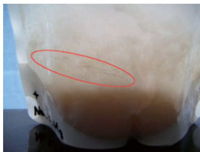
図 5 パウチ損傷の様子
