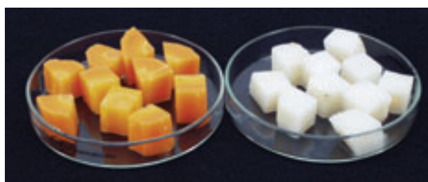
図6 液部が2000mPa・s(80℃)の場合の撻動殺菌後の固形物
