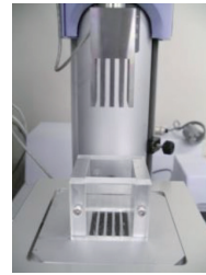
ミニクラマーシアセルでの試験片破断
