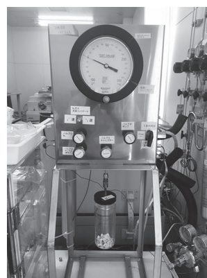
写真2 マニュアル式ガス希釈装置使用の様子
